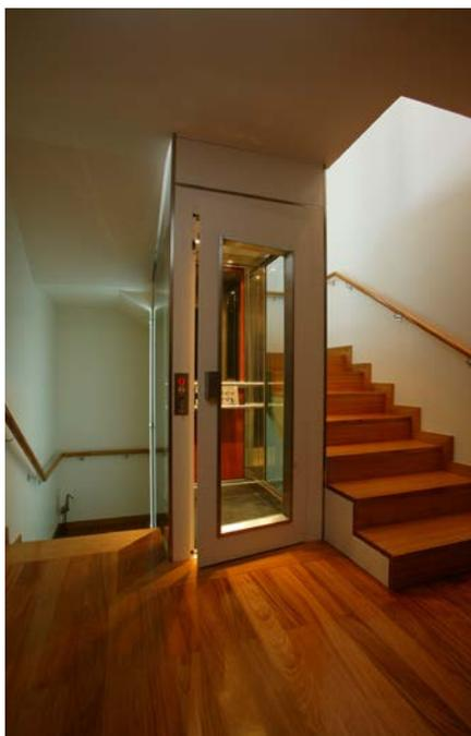
Figura 1 Homelift com acionamento hidráulico aplicado no vão de escadas de uma moradia.
